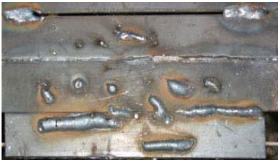
Helytelenül tartott és vezetett elektróda által készített varrat képek.
