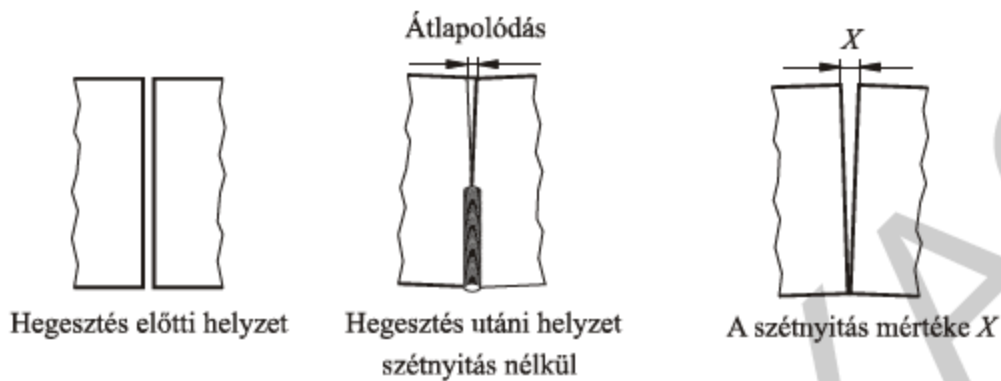
12. ábra: Hő okozta elhúzóadás megakadályozása
